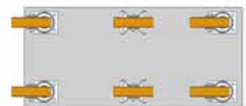
Fire svingbare og to faste hjul med lik byggehøyde
