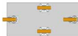
To svingbare hjul og to faste hjul, hvor de faste hjulene har en noe høyere byggehøyde.
