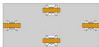
Fire faste hjul, hvor de midterste har en noe høyere byggehøyde.
